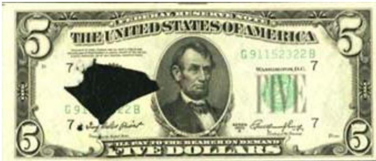
Este error se podría tomar como error por adición (en este caso es falta) de no ser porque se conoce el siguiente billete y en él quedó la impresión litográfica que debía de estar en este ejemplar. Al quedar el hueco, la mantilla queda con la tinta que no pasó por la falta de papel y esa tinta se pega en el siguiente en el anverso:
